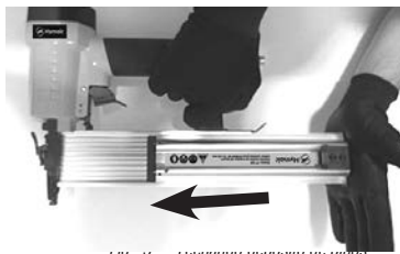
Fig. 5 - Cerrando depósito de clavos
