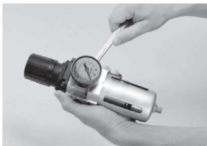
Fig. 6 – Apertar o manômetro
