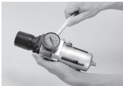
Fig. 6 – Apretar el manómetro
