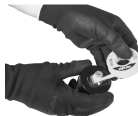
Fig. 6 – Aplicar fita veda rosca
