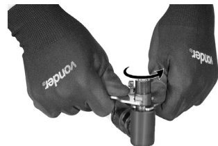
Fig. 2 – Soltando la tuerca de la pinza
