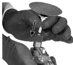
Fig. 3 – Instalando um acessório
