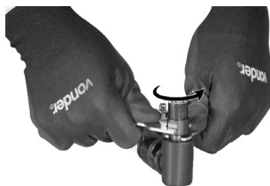
Fig. 2 – Soltando a porca da pinça
