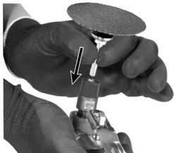
Fig. 3 – Instalando un accesorio
