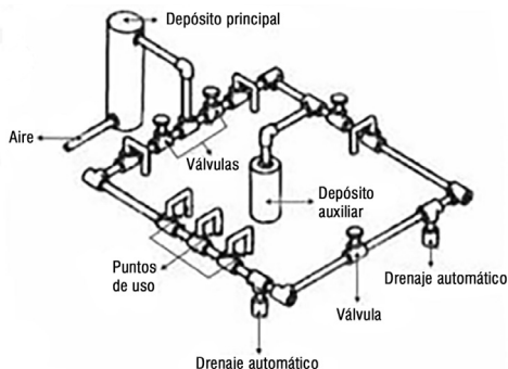
Fig. 2 – Red de aire comprimido
