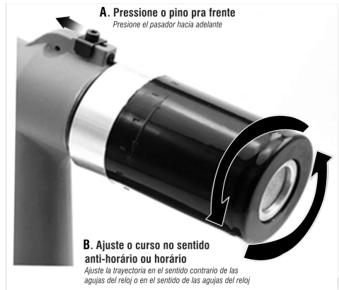
Fig. 2 – Ajuste de la trayectoria de la tracción
