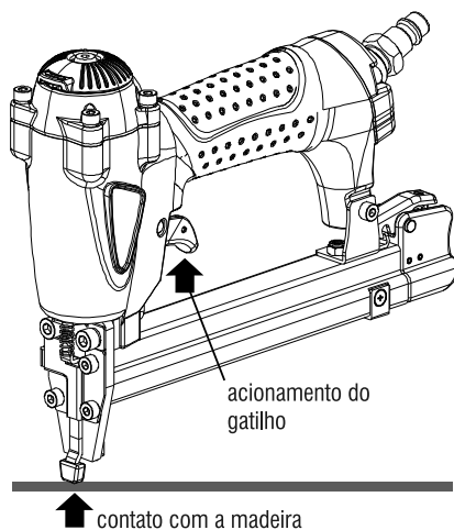
Fig. 5 – Acionamento do grampeador
