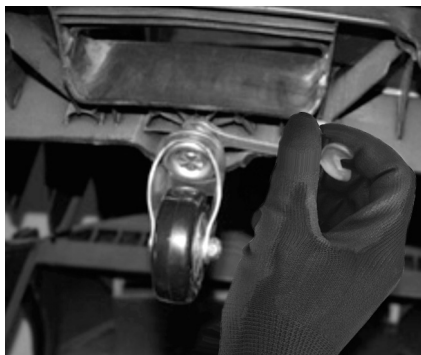
Fig. 10 – Reapriete del perno de la rueda
