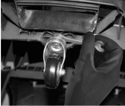
Fig. 10 – Reaperto do parafuso do rodízio
