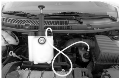
Fig. 3 – Equipamento conectado ao reservatório do fluido de freio do veículo
