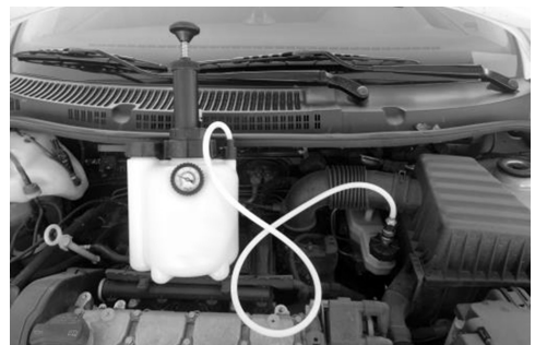
Fig. 3 – Equipo conectado al reservatório del fluido de freno del vehículo
