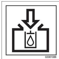
Enchimento do depósito do óleo hidráulico
