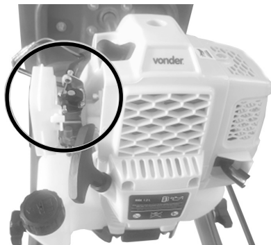
Fig. 6 – Montagem do cabo do acelerador
