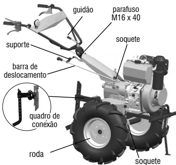
Fig. 3 – Montagem do equipamento
