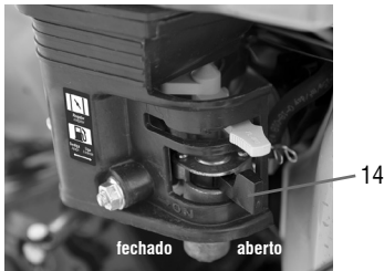
Fig. 7 – Válvula de combustível
