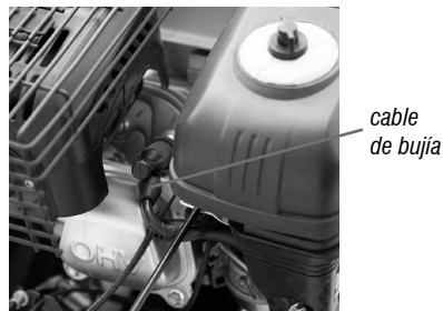
Fig. 26 – Desmontaje de la bujía
