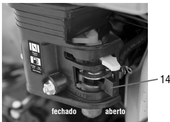
Fig. 16 – Válvula de combustível
