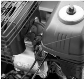
Fig. 16 – Removendo a vela
