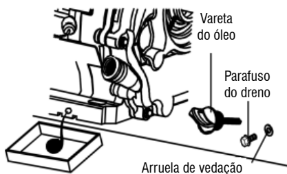
Fig. 14 – Troca de óleo do motor
