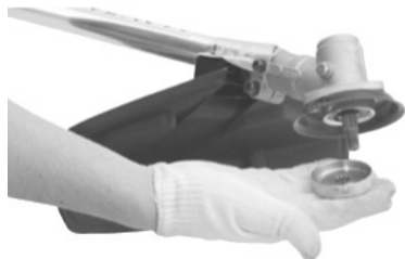
Fig. 12 – Montagem da flange interna
