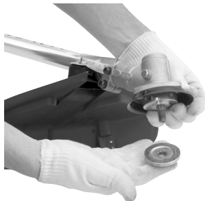
Fig. 13 – Montaje de la brida externa
