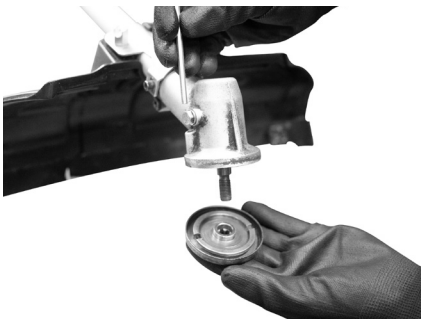
Fig. 6 – Montagem da flange interna
