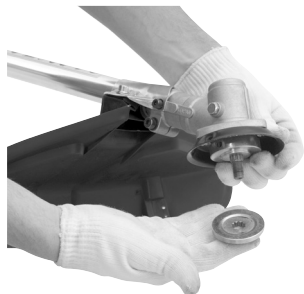
Fig. 13 – Montagem da flange externa
