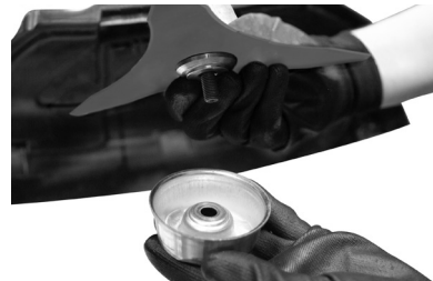
Fig. 10 – Colocando a flange de proteção
