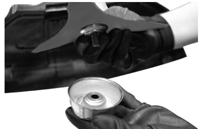
Fig. 10 – Colocación de la breda de protección
