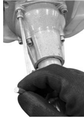
Fig. 20 – Acoplado o tubo no motor.
