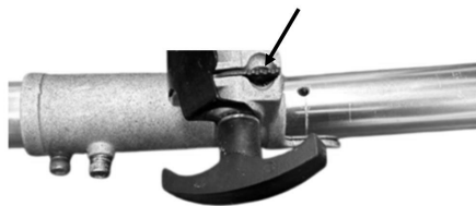
Fig. 18 – Traba del tubo
