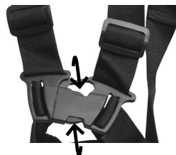
Fig. 25 – Remover o cinto duplo
