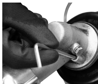
Fig. 12 – Trabando el eje
