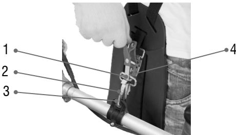
Fig. 27 – Fixando a roçadeira ao cinto
