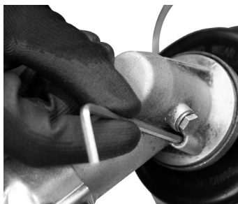
Fig. 12 – Travando o eixo
