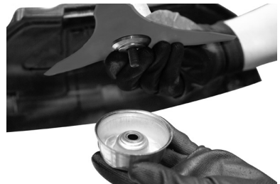
Fig. 9 – Colocando la brida de protección
