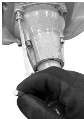
Fig. 20 – Acoplado el tubo al motor.
