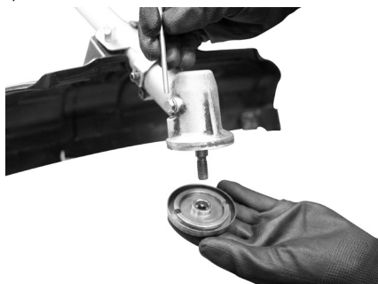
Fig. 5 – Montagem da flange interna
