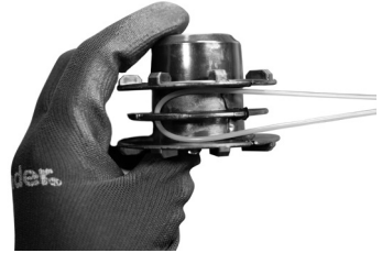
Fig. 15 – Pasando el hilo de nylon
