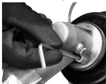
Fig. 6 – Travando o eixo
