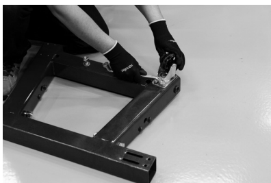
Fig. 2 – Montaje de las ruedas en la base
