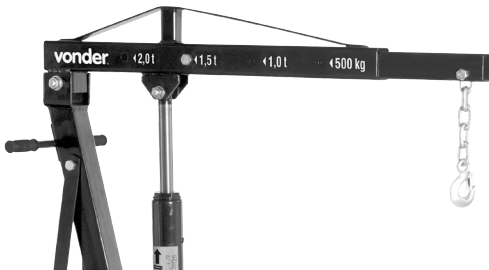
Fig. 11 – Ajuste do prolongador e capacidade de carga
