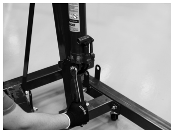
Fig. 7 – Montaje del sistema hidráulico
