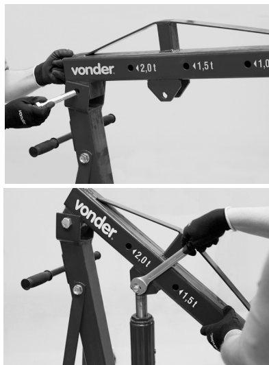
Fig. 8 – Montagem do braço
