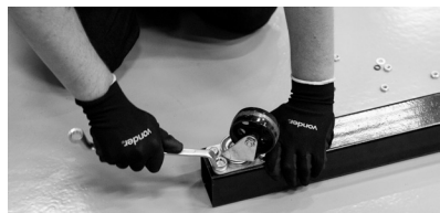
Fig. 3 – Montagem dos rodízios nos pés do guincho.
