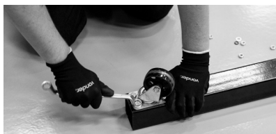
Fig. 3 – Montaje de las ruedas en los pies del guinche
