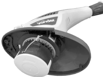
Fig. 5 – Instalação da proteção de segurança
