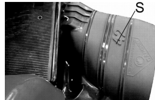
Fig. 8 – Protección del deflector
