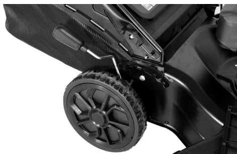
Fig. 6 – Regulación de la altura de corte
