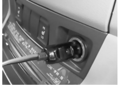
Fig. 6 – Carga a través de una toma de 12 V
