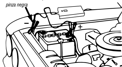
Fig. 7 – Cargar la batería en el vehículo
