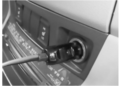
Fig. 6 – Carga a través de una toma de 12 V
