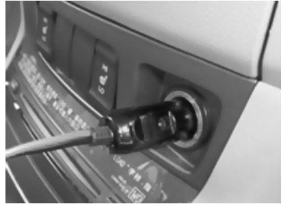
Fig. 6 – Carregamento através da tomada 12 V
