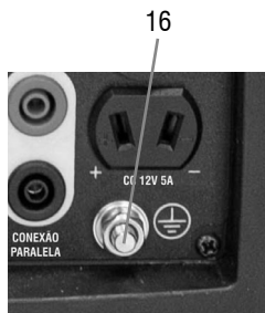
Fig. 10 – Terminal de aterramento
