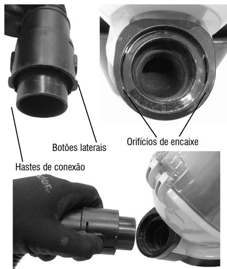
Fig. 3 – Conexão da mangueira flexível
