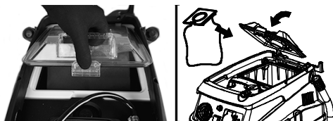
Fig. 3 – Instalando el saco colector en la boquilla de succión superior
