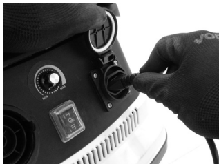
Fig. 10 – Conectando o plugue da ferramenta elétrica na tomada do equipamento
