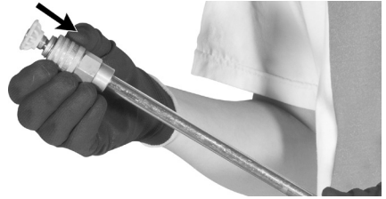
Figura 11 – Montaje de la boquilla
