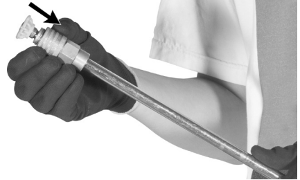
Figura 11 – Encaixando o bico
