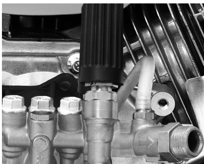
Figura 25 – Conectando a mangueira do detergente na bomba
