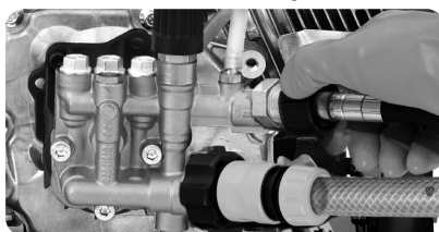
Figura 14 – Conectando a mangueira de alta pressão
