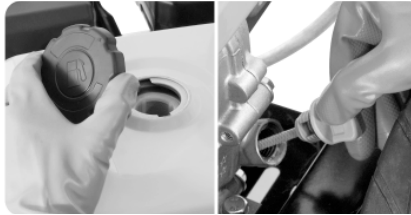
Figura 18 – Verificando el nivel de aceite y gasolina
