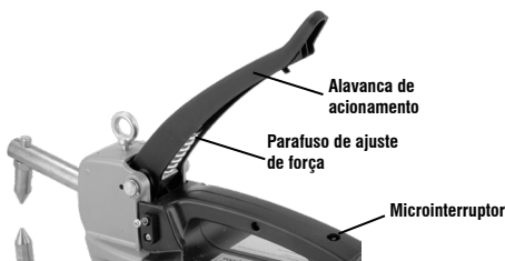
Fig. 4 – Ajuste de força
