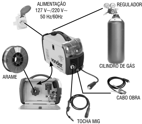
Fig. 2 – Montagem do conjunto
