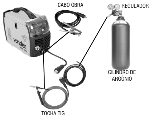
Fig. 10 – Montagem do conjunto
