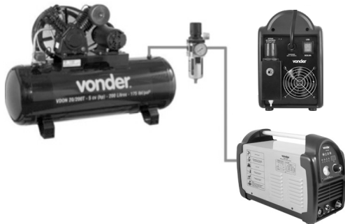
Fig. 1 – Suministro de aire comprimido
