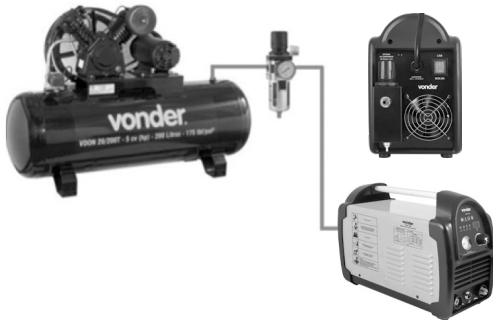
Fig. 1 – Suprimento de ar comprimido
