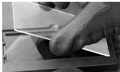
Fig. 6 – Inserte el nuevo lente interno
