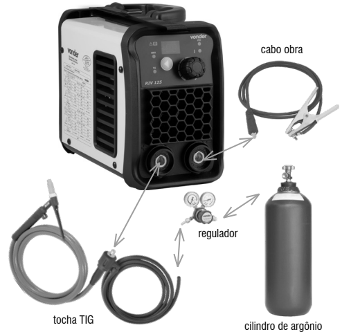
Fig. 3 – Montagem do conjunto
