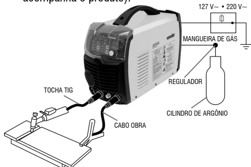
Fig. 3 – Montagem do conjunto para soldagem TIG
