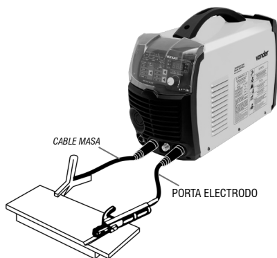
Fig. 10 – Montaje de los cables de soldadura para soldadura de Electrodo Revestido (MMA)
