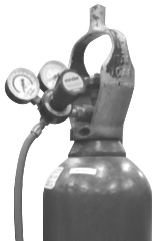
Fig. 3 – Instalação do gás
