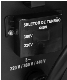
Fig. 2 – Selector de tensión
