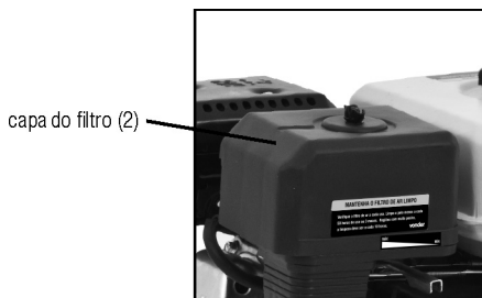
Fig. 11 – Capa do filtro de ar
