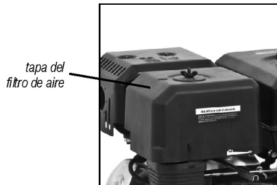
Fig. 13 - Tapa del filtro de aire
