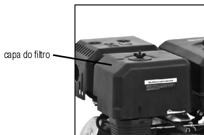
Fig. 13 – Capa do filtro de ar
