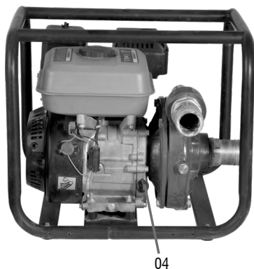
Fig. 5 – Tampa do reservatório de óleo (vareta)
