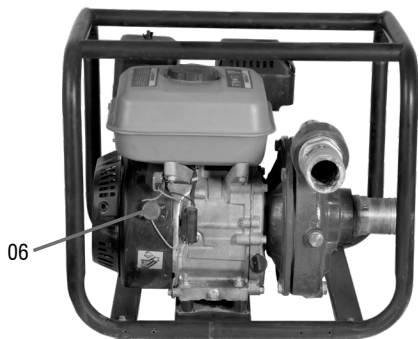
Fig. 11 – Chave geral (liga/desliga)
