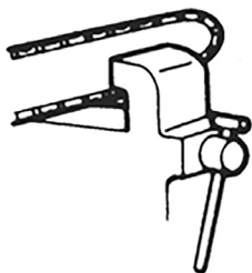
Fig. 20 – Fixação da Eletrosserra
