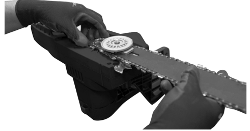
Fig. 5 – Montaje del sable y cadena de corte
