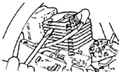
Fig. 44 – Limpeza das aletas do cilindro
