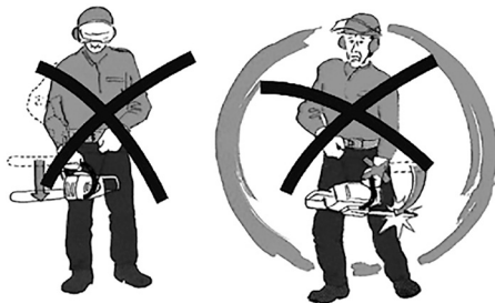
Fig. 19 – Maneras incorrectas de dar la partida en la motosierra
