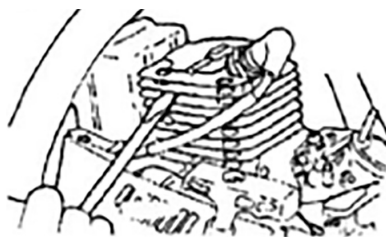
Fig. 44 – Limpieza de las aletas del cilindro
