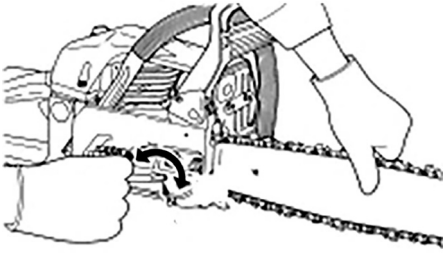
Fig. 14 – Ajuste del tensionamiento de la cadena
