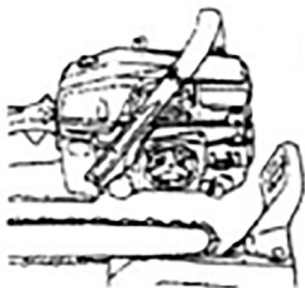
Fig. 22 – Orifício de saída de óleo de lubrificação da corrente
