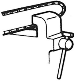
Fig. 28 – Fijando el sable en un torno/morsa
