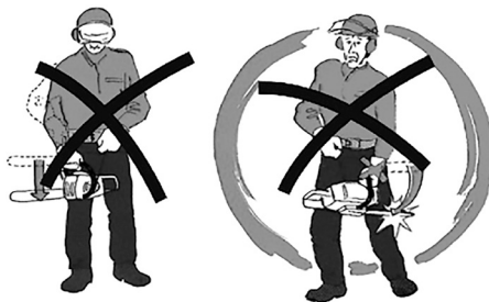
Fig. 19 – Maneiras incorretas de dar a partida na motosserra
