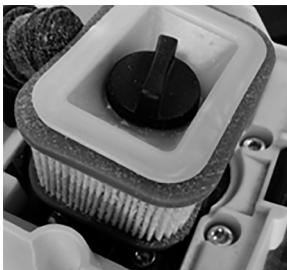
Fig. 44 – Limpeza do filtro de ar
