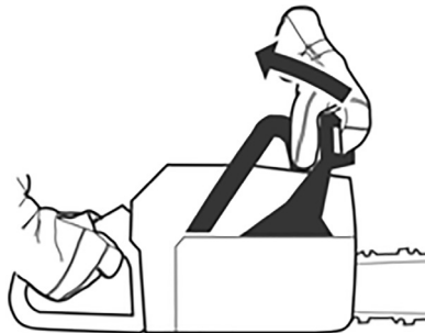
Fig. 35 – Destravando a corrente
