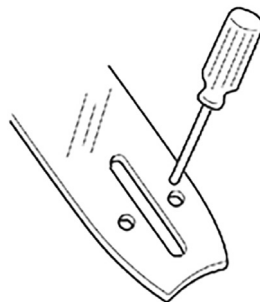
Fig. 21 – Limpeza do furo de lubrificação
