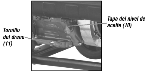
Fig. 7 – Tapa del nivel de aceite (varilla)
