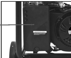
Fig. 21 – Retirando la tapa del filtro de aire
