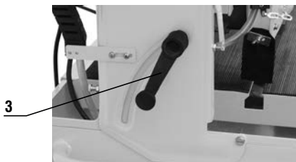
Figura 8 – Ajuste de ângulo do cabeçote de corte
