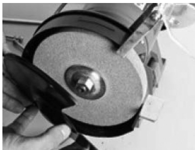
Fig. 7 – Remoção da tampa do rebolo
