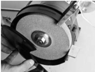
Fig. 7 – Eliminación de la tapa de la muela
