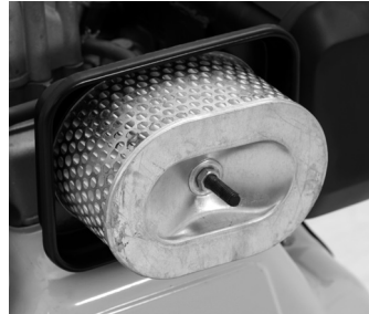
Figura 23 – Retirando la tapa del filtro de aire
