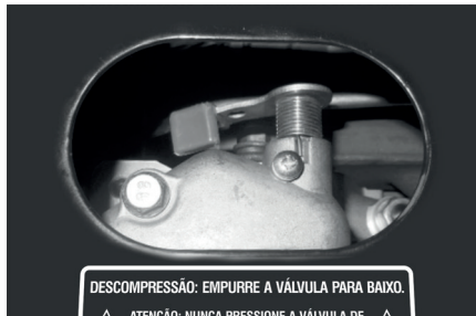
Figura 12 – Acionando a válvula de descompressão
