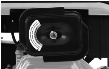
Figura 23 – Retirando la tapa del filtro de aire
