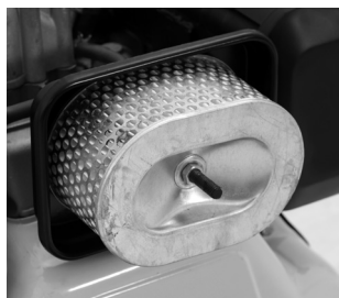
Figura 23 – Retirando a tampa do filtro de ar
