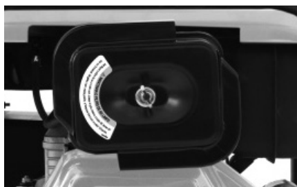
Figura 23 – Retirando a tampa do filtro de ar
