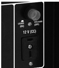
Figura 15 – Disyuntor del circuito CC
