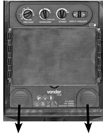
Fig. 3 – Sustitución de las baterías
