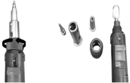
Fig. 6 – Desmontando el conjunto de soldadura
