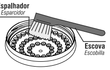
Figura 05 - Limpeza do espalhador
