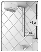
Figura 04 - Instalação e utilização do desviador
