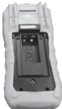
Fig. 3 – Sustitución de la batería
