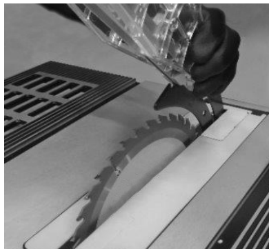
Fig. 12 – Montando a proteção da lâmina
