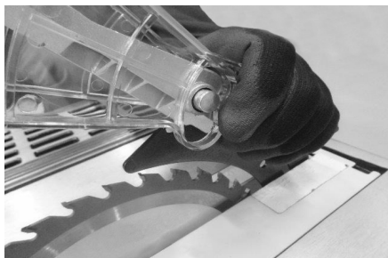
Fig. 13 – Trava de proteção da serra
